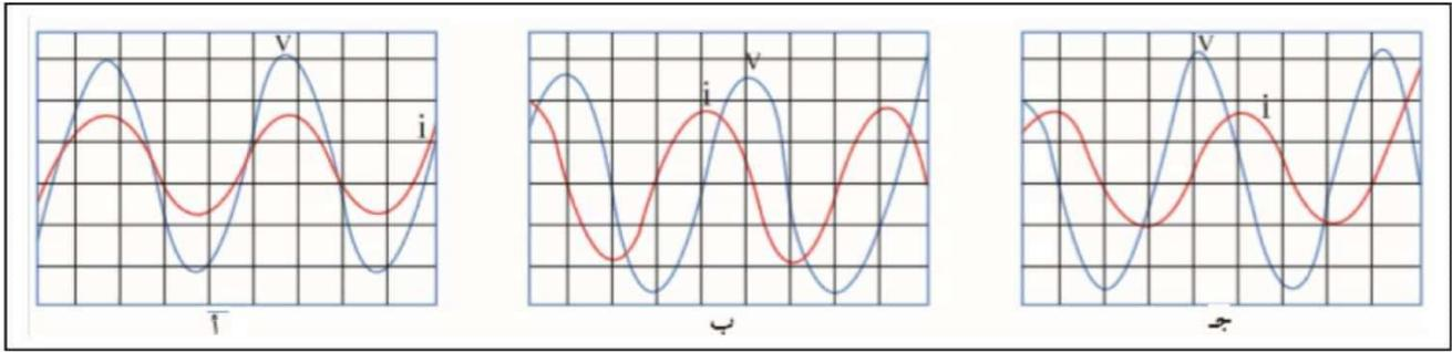
مثال  $\frac{6}{55}$  دائرة توالي مؤلفة من مكثف سعته  $1 \mu\text{f}$  و ملف تأثيرى نقي له معامل حث ذاتى يساوى  $70 \text{ mH}$  و مقاومة  $60 \Omega$  متصلة بمصدر جهد متردد جهده الفعال  $220 \text{ V}$
